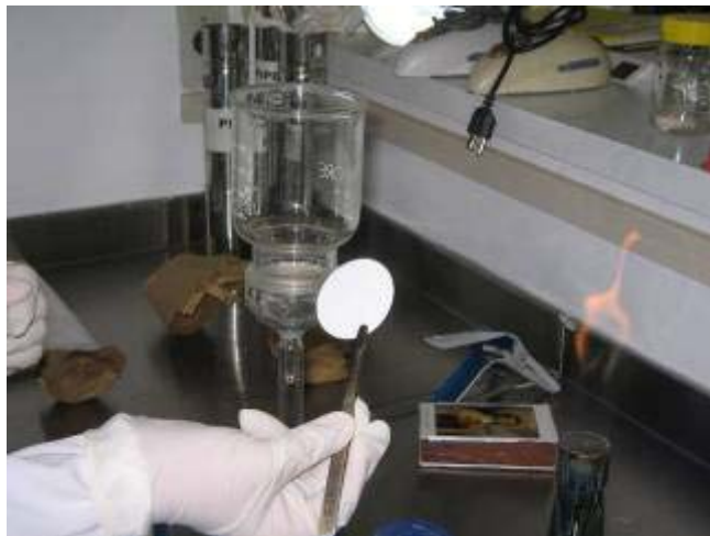
Foto 14 – Técnica da membrana filtrante, LACEN/CE Fonte: Autora, 2007
