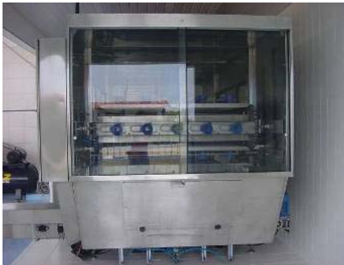
Foto 36 – Lavadora interna automática (MAQ 200) – Mineradora Límpida Fonte: Autora, 2007
