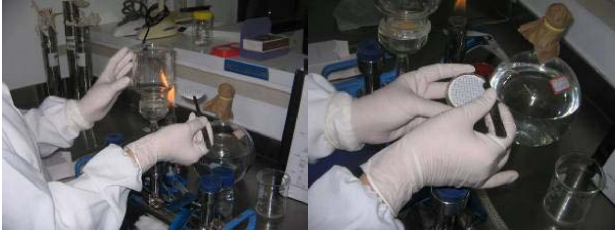
Foto 16 – Membrana filtrante colocada no meio de cultura, LACEN/CE Fonte: Autora, 2007
