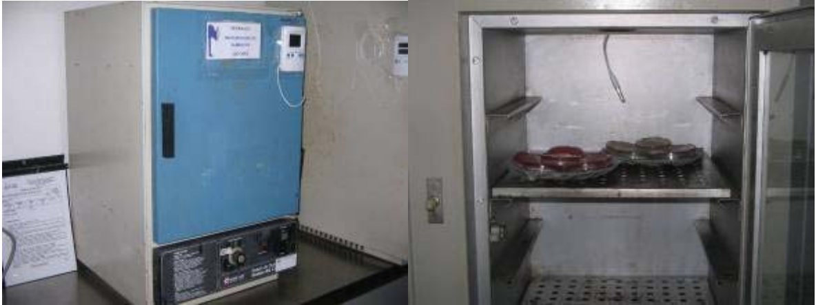
Foto 18 – Incubadora para meio de cultura por membrana filtrante, LACEN/CE Fonte: Autora, 2007
