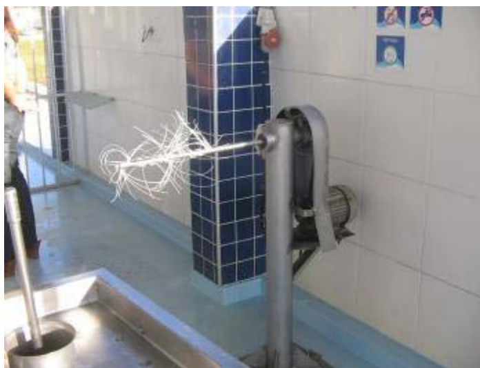
Foto 37 – Lavadora interna para vasilhames de 20 litros – Mineradora Límpida Fonte: Autora, 2007
