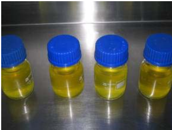
Foto 11 - Resultado positivo para análise de coliformes totais, LACEN/CE Fonte: Autora, 2007
