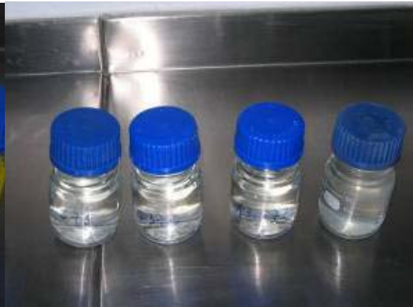
Foto 12 – Resultado negativo para análise de coliformes totais, LACEN/CE Fonte: Autora, 2007
