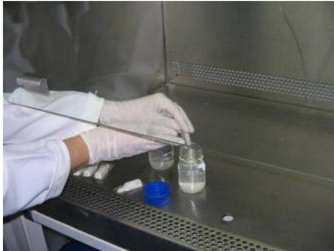
Foto 9 – Adição do substrato a 100 mL de água, LACEN/CE Fonte: Autora, 2007
