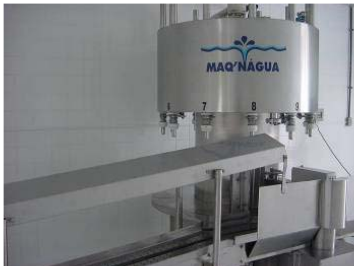
Foto 38 - Enchedora rotativa automática (MAQ 250) – Mineradora Límpida Fonte: Autora, 2007
