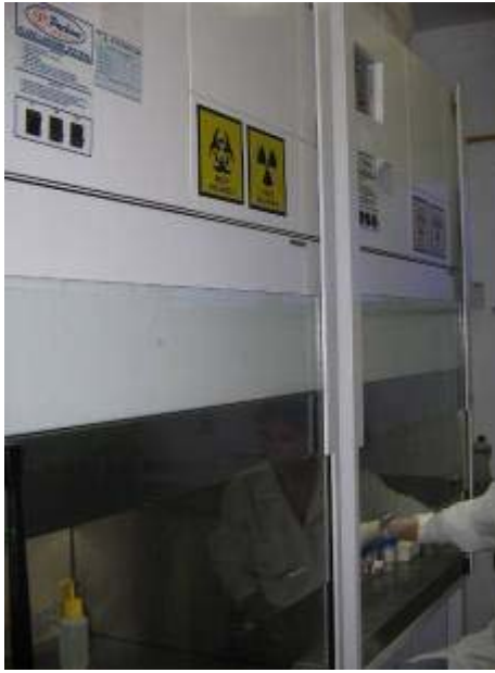
Foto 7 – Câmara de fluxo laminar, LACEN/CE Fonte: Autora, 15 out 2007
