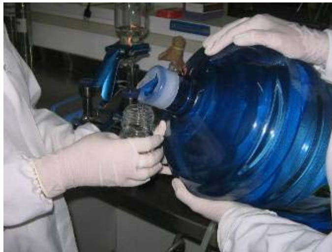
Foto 6 – Coleta de amostra para análise de coliformes totais e Escherichia coli , LACEN/CE Fonte: Autora, 2007
