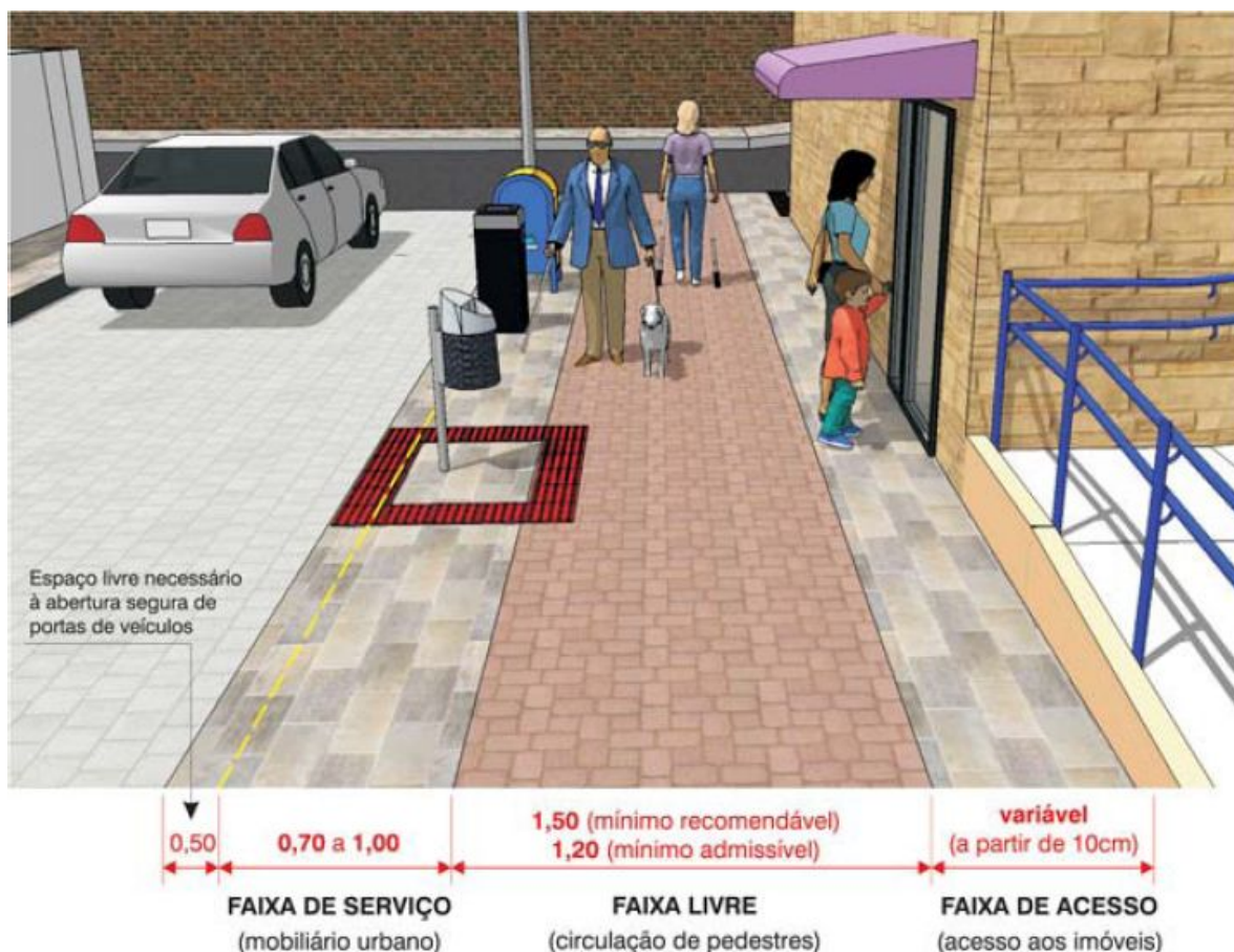
Figura IV-3.1: Faixas da calçada com apresentação de piso de acordo com a NBR 9050/2004. Fonte: Dutra et al. (2009)
