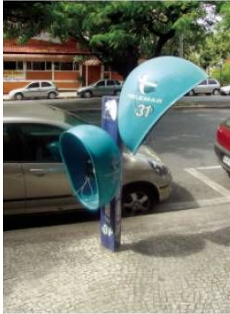
Figura IV-3.17: Telefone público com altura adaptada, porém não sinalizado
