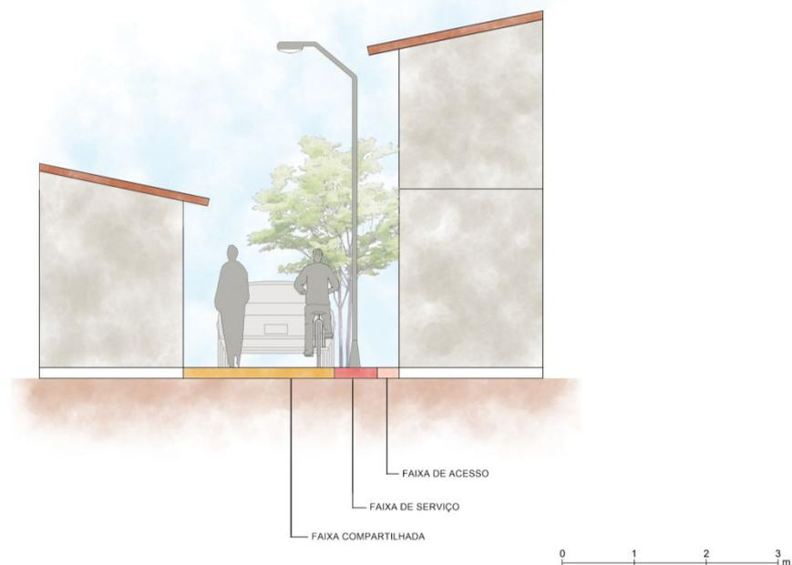
**Figura 10:** Corte esquemático da via compartilhada tipo A
