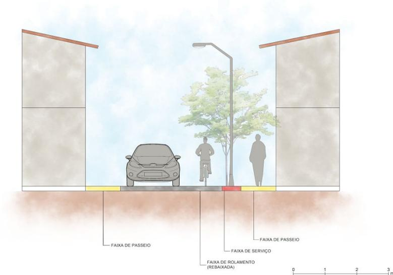
**Figura 12:** Corte esquemático da via local especial tipo A
