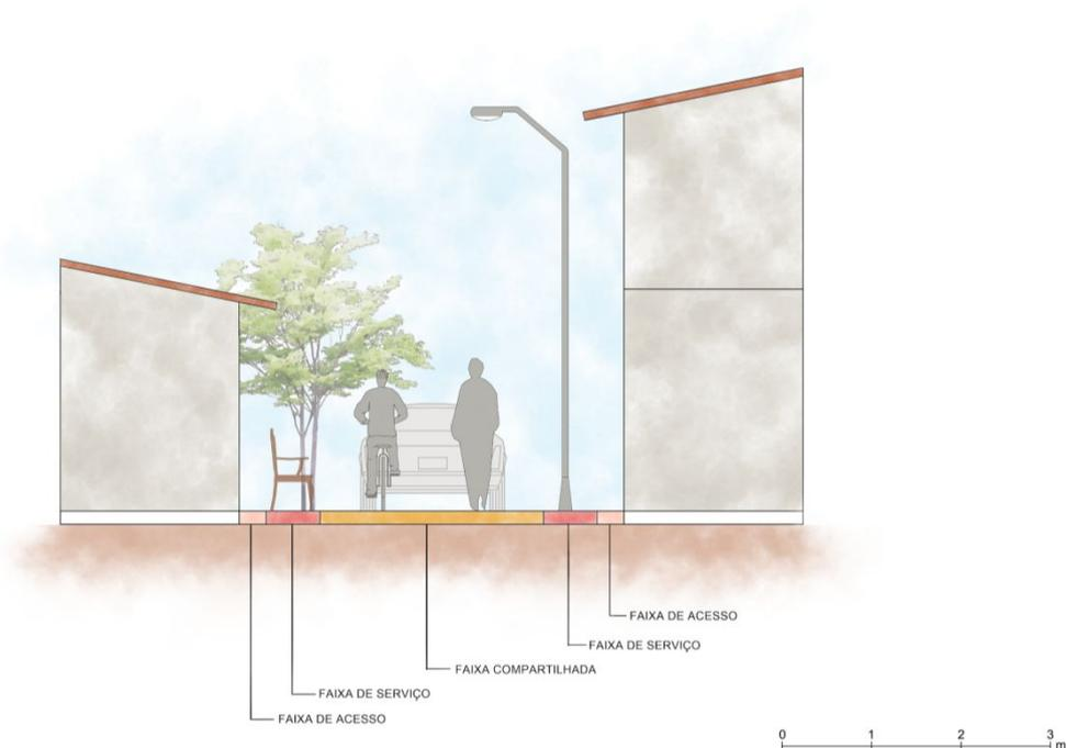
**Figura 11:** Corte esquemático da via compartilhada tipo B
