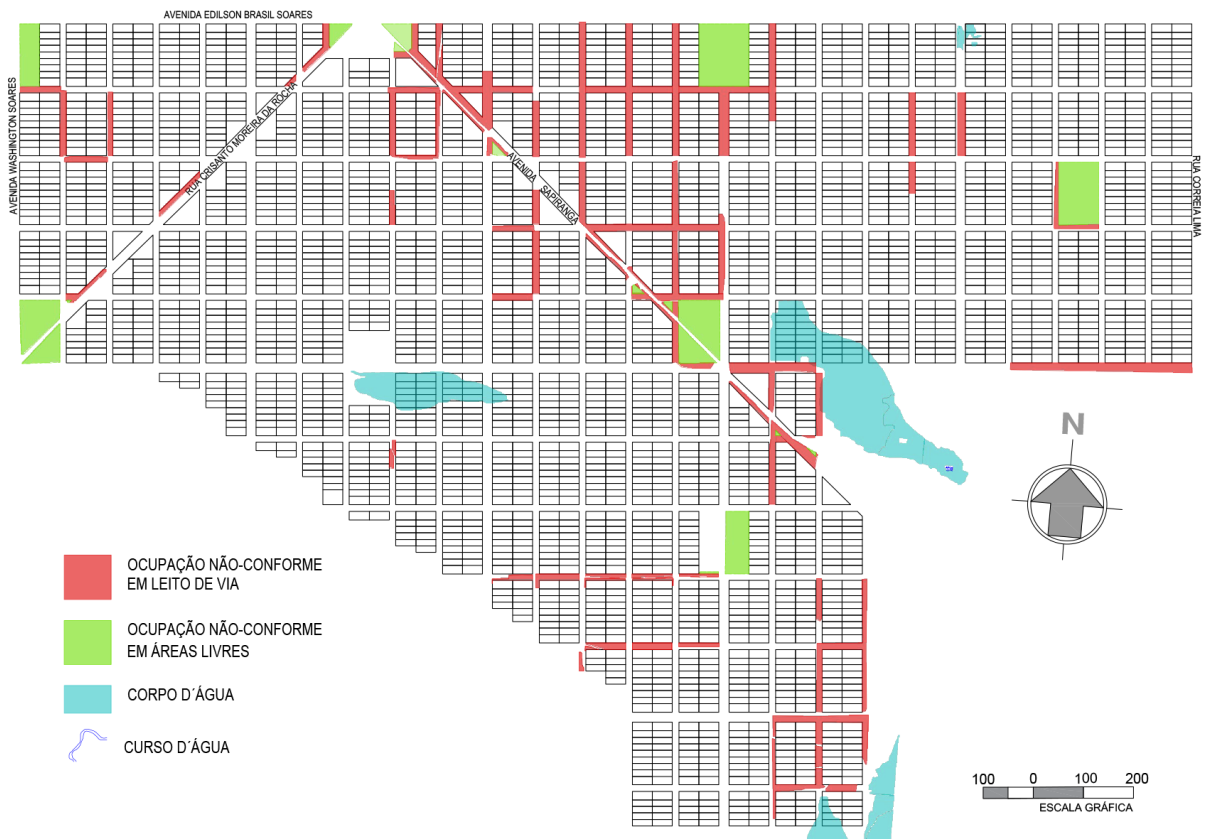
Figura 5.6: Áreas públicas ocupadas em desconformidade com a planta de loteamento.
