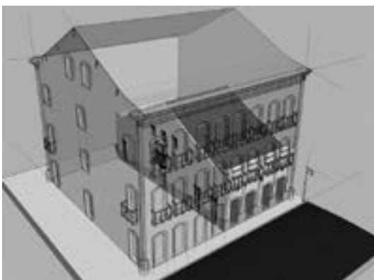
Figura 23: simulação – edificação antiga e remanescentes após o processo demolitório (autor, 2009).
