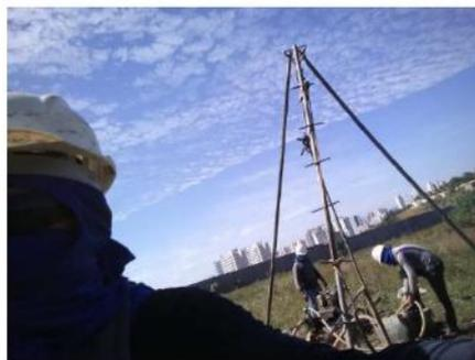
**Foto 01** - Detalhe da montagem da torre de sondagem para iniciar o serviço de determinação do SPT do terreno.
