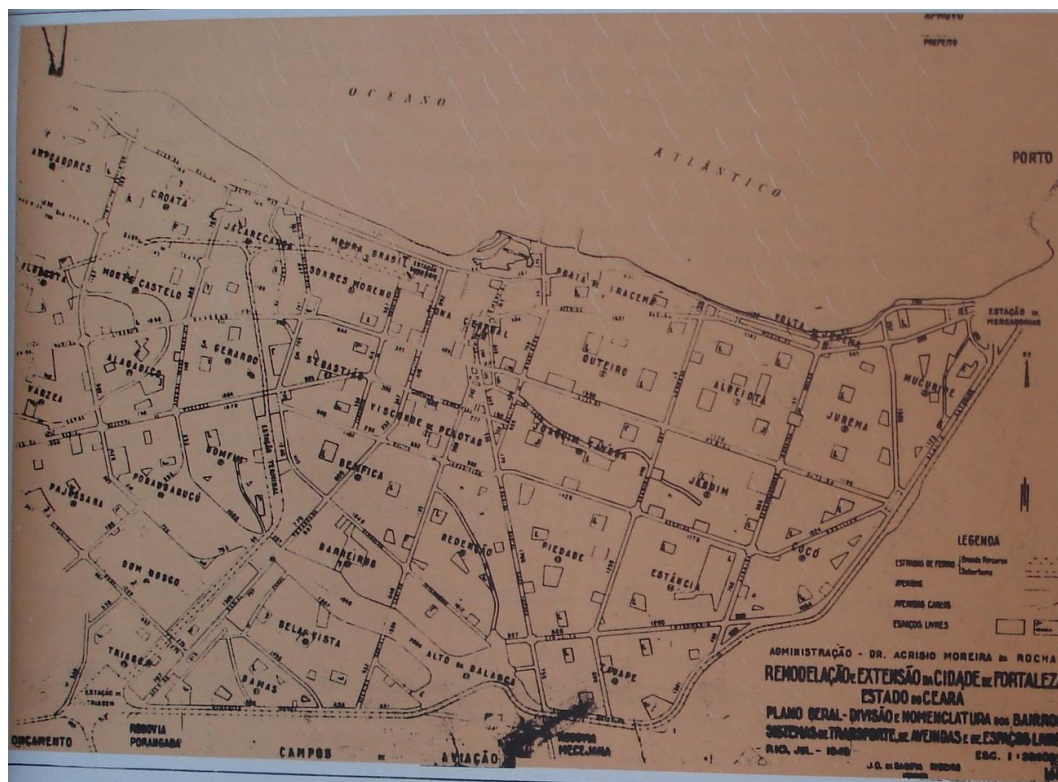
Figura 2 – Planta do sistema viário do Plano Diretor para Remodelação e Extensão de Fortaleza, elaborado por Saboya Ribeiro, que propõe um sistema de vias principais para a cidade, denominado “circuitos”.
