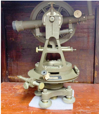
Imagem 8 - Teodolito. Equipamento utilizado para levantamento topográfico através da medição dos ângulos verticais e horizontais de um terreno (Século XX) Fonte: O autor.
