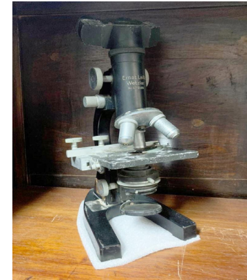
Imagem 7 - Microscópio óptico binocular com três objetivas. Aparelho utilizado em laboratório para visualização de estruturas minúsculas. Ampliação 125x (Circa 1970) Fonte: O autor.
