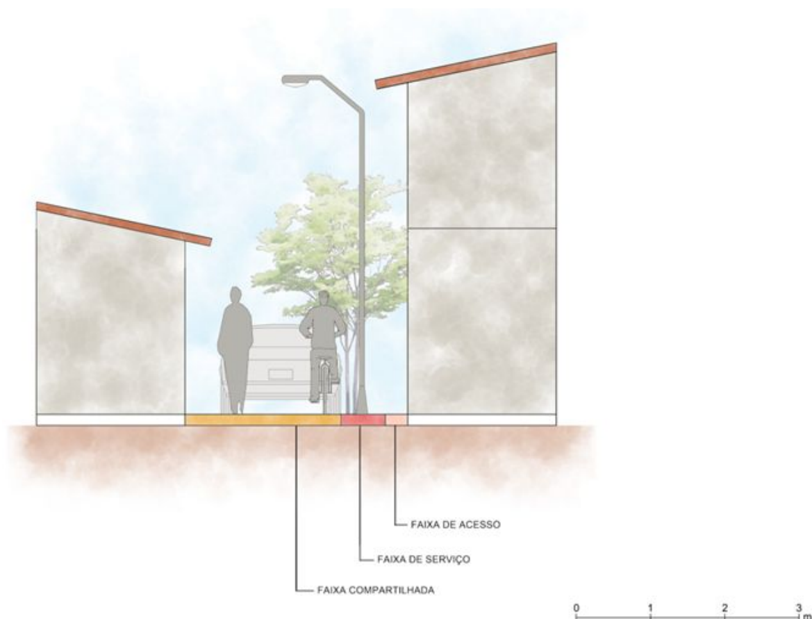
Figura 08: Corte esquemático da via compartilhada tipo A.
