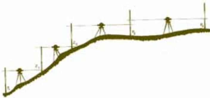
Fig. 2.23 – Nivelamento efetuado por meio de nível ótico e mira graduada.
