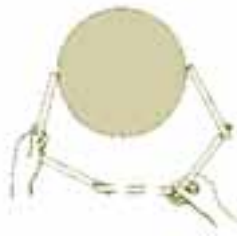
Fig. 2.18 – Medição do diâmetro com trena dobrável.
