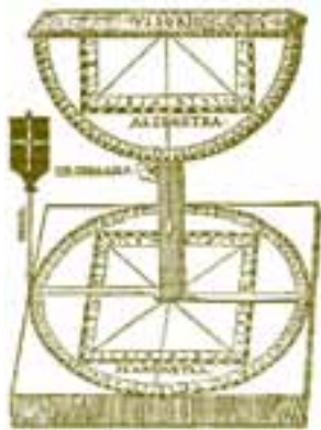
Fig. 1.8 – Visório , evolução quinhentista do instrumento de Heron de Alexandria.
