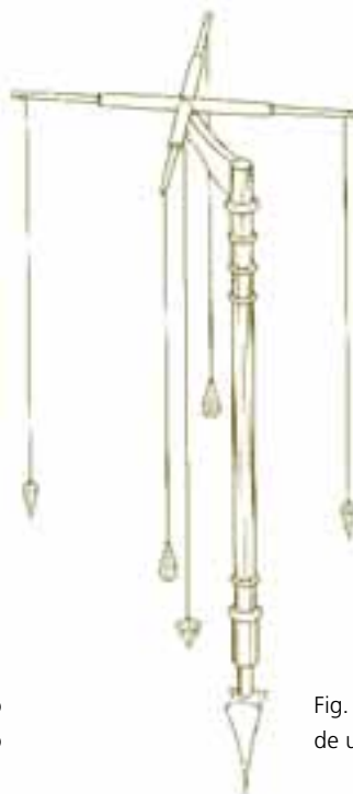
Fig. 1.6 – Reconstituição de uma dióptera, segundo Venturi (1814).
