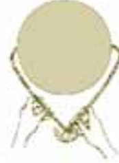
Fig. 2.20 – Medição do diâmetro com compasso de pontas curvas.
