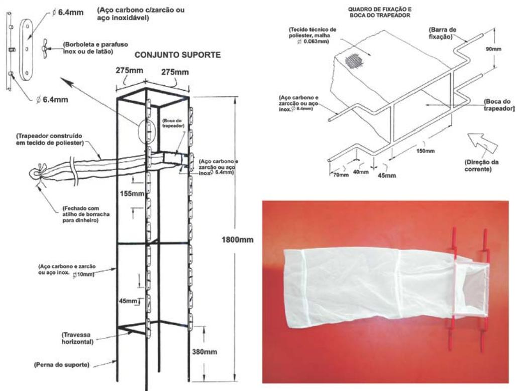
**Figura 9:** Detalhes construtivos das armadilhas de sedimentos. Modificado de Fontoura (2004).
