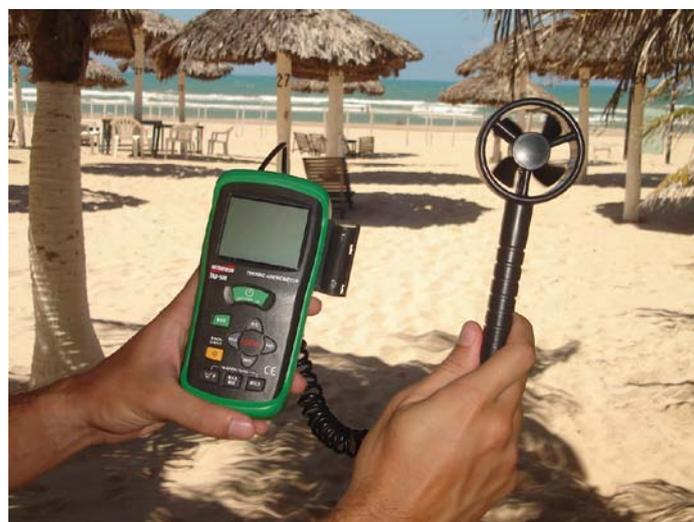
**Figura 10:** Anemômetro portátil.
