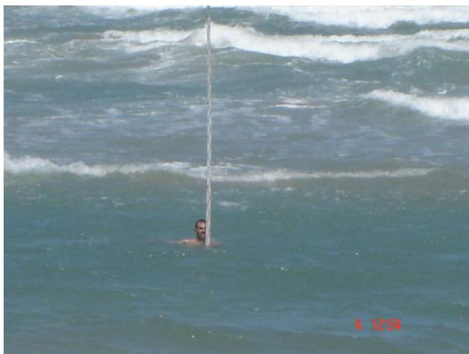
**Figura 6:** Medição da altura significativa de ondas com auxílio de uma régua de 5m.
