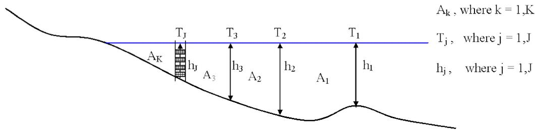
**Figura 8:** Esquema proposto por Fontoura (2004) para a instalação dos trapezoides ( $T_j$ ) com a profundidade local ( $h_j$ ) em uma área entre dois trapezoides consecutivos ( $A_k$ ). Modificado de Fontoura *et al.* (2006).
