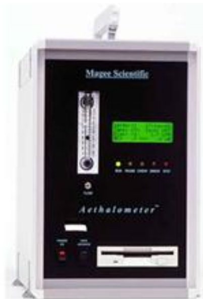
Figura 20 – Aetalômetro – medidor de Fumaça preta ( black carbon ) pertencente ao LAPAt (IAG – USP) Fonte: LAPAt (2009)
