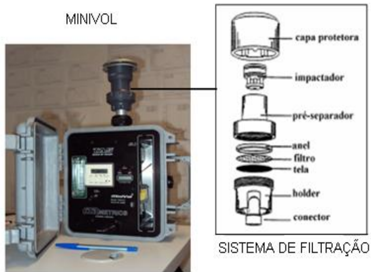
Figura 18 – Foto: Amostrador de material particulado (Minivol) e Sistema de filtração
