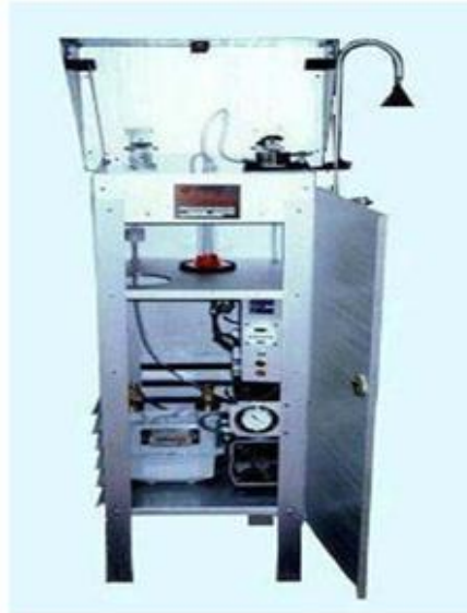
Figura 15 - Amostrador de Pequeno Volume (APV) para medida simultânea de \text{SO}_2 e Fumaça Preta. Fonte: Energética
