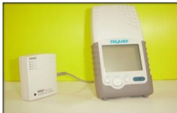
Figura 23 - Telaire 7001 - Sensor automático para medir CO 2 com HOBOLogger U12 013 Fonte: Banco de dados do LERCA (2009)
