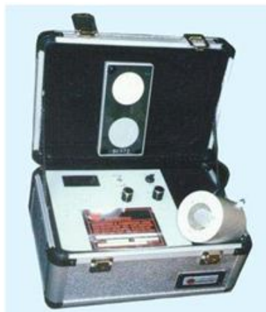
Figura 16 - Analisador da refletância da luz em filtros para a determinação da concentração de Fumaça Preta Fonte: Energética
