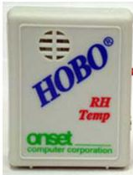
Figura 24 - HOBO H 08 Sensor de temperatura e umidade Fonte: Banco de dados do LERCA
