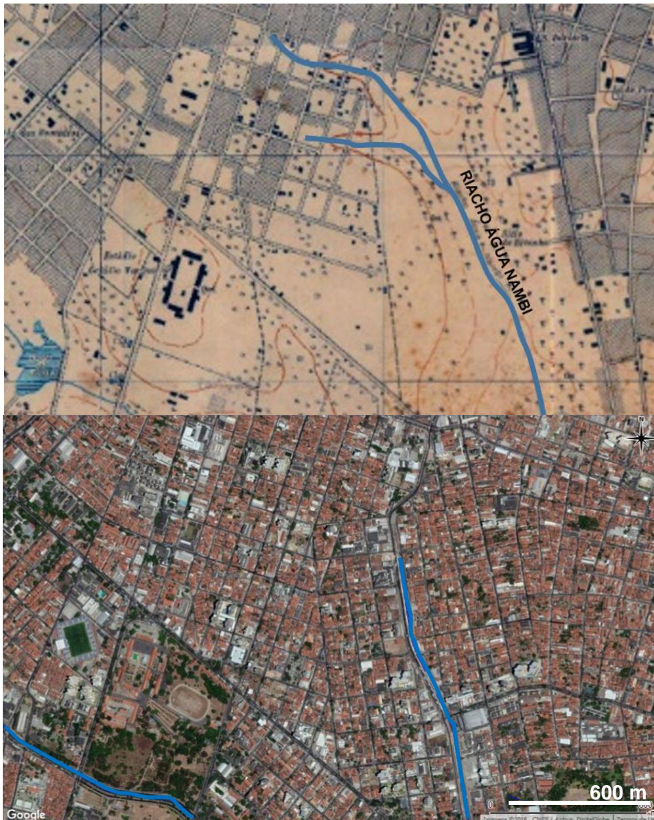
Figura 20- Detalhe da Carta da Cidade de Fortaleza e arredores. Levantada, desenhada e impressa pelo Serviço Geográfico do Exército, 1945. Vê-se o Riacho Água Nambi antes de sua canalização (acima) e foto aérea registrada em 2017 (abaixo).
