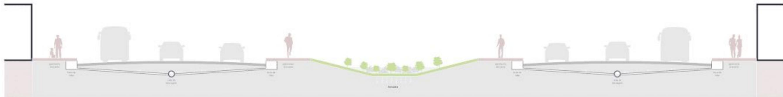
**Figura 19.** Representação sistema de drenagem na Av. Coronel Matos Dourado. **Fonte:** PIRF - UFC.
