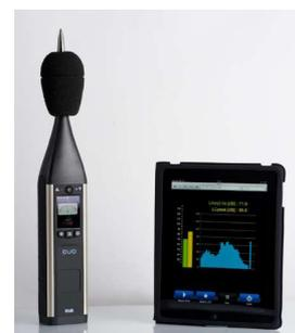
Fig. 2 – Sonômetro 01dB DUO
