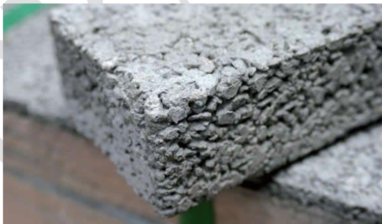
Figura 64. Pavimento de concreto permeável. Fonte: PINI (2011).
