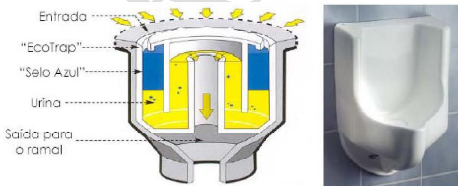
Figura 61. Esquema de um mictório sem uso de água e vista do aparelho. Fonte: SCHERER, 2003.
