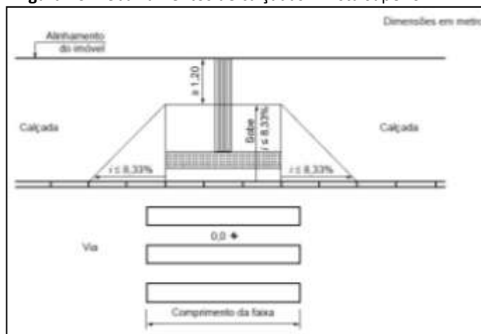
Figura 10. Rebaixamentos de calçadas – Vista superior
