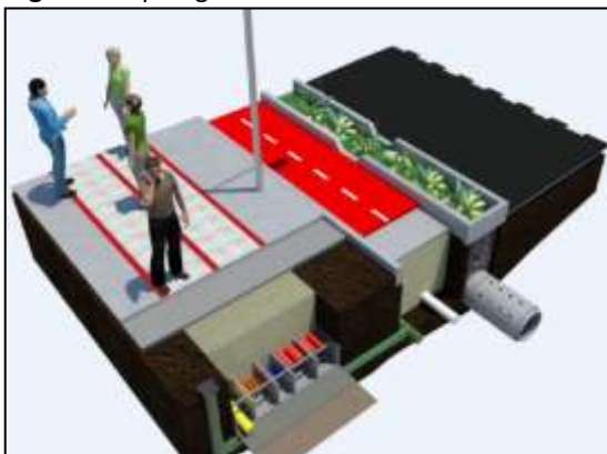
Figura 9: Tipologia básica do modelo de vala técnica
