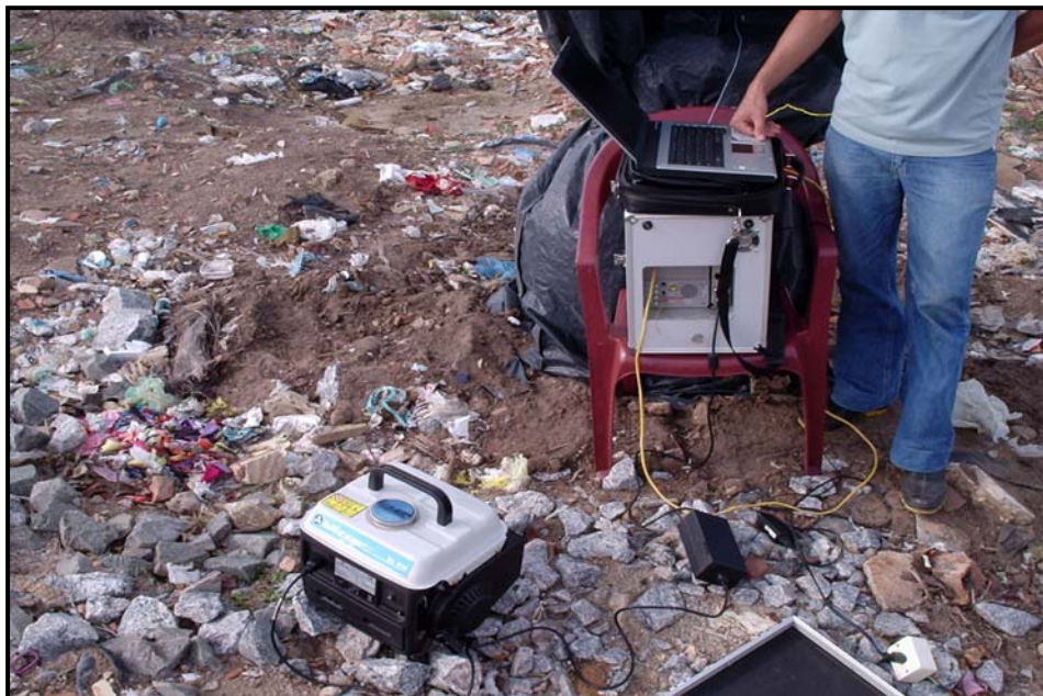
Medição de gases com o aparelho Cromatógrafo em drenos encamisados
