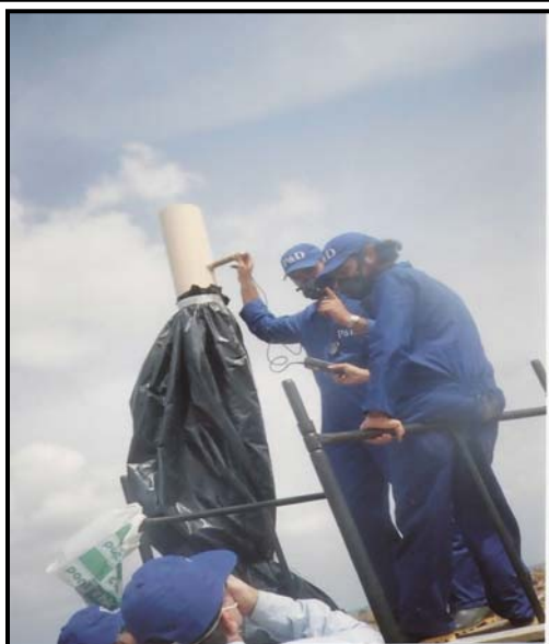
Medição de temperatura e velocidade de gases com aparelho Termoneamometro
