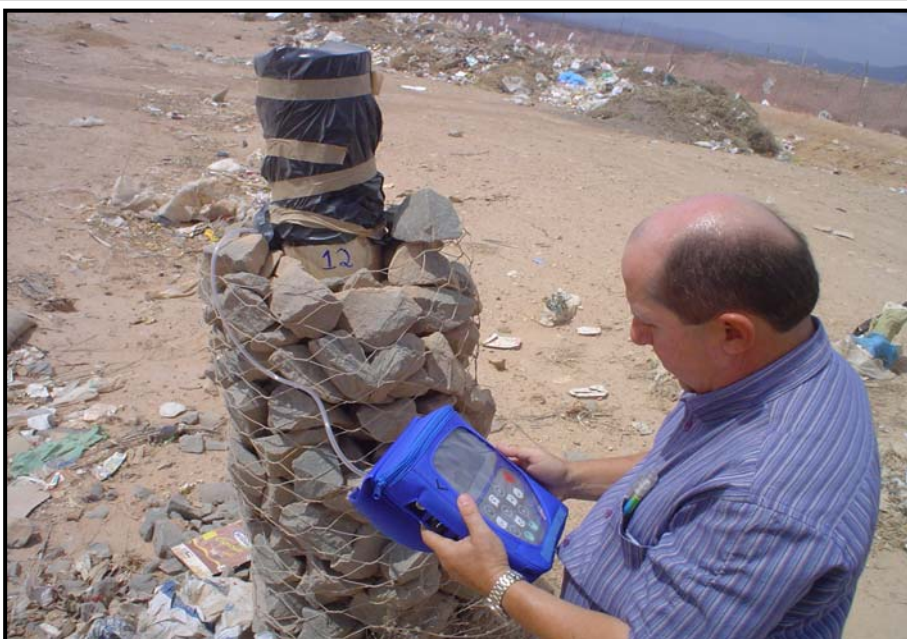
Medição do percentual de CH 4 , CO 2 e O 2 com o aparelho GEE 2000 (Gasômetro). Célula selada por 24 horas e tempo de medição de 10 segundos
