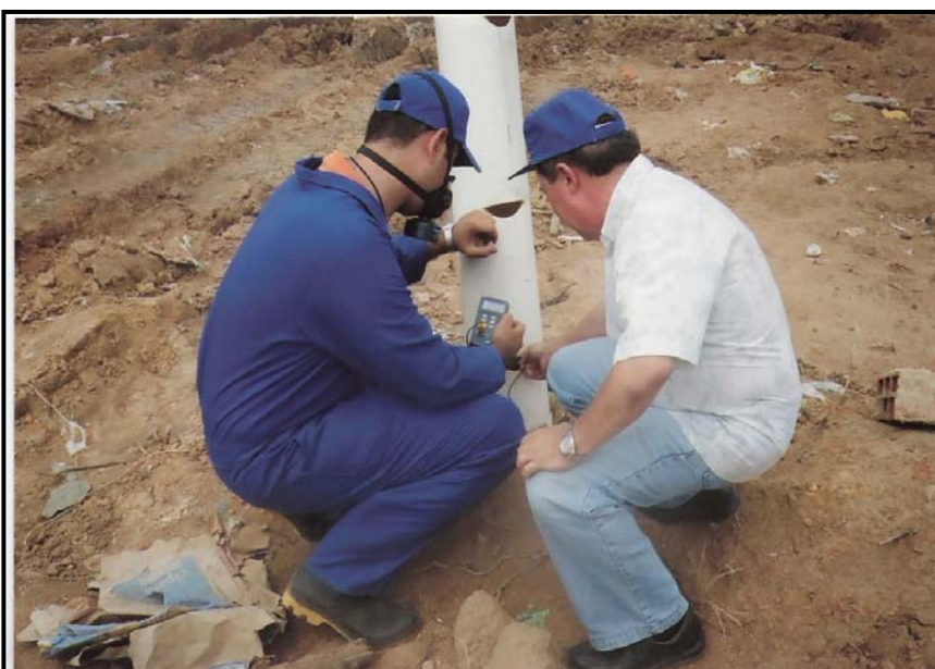
Medição de velocidade e temperatura no interior do dreno com a presença de O 2
