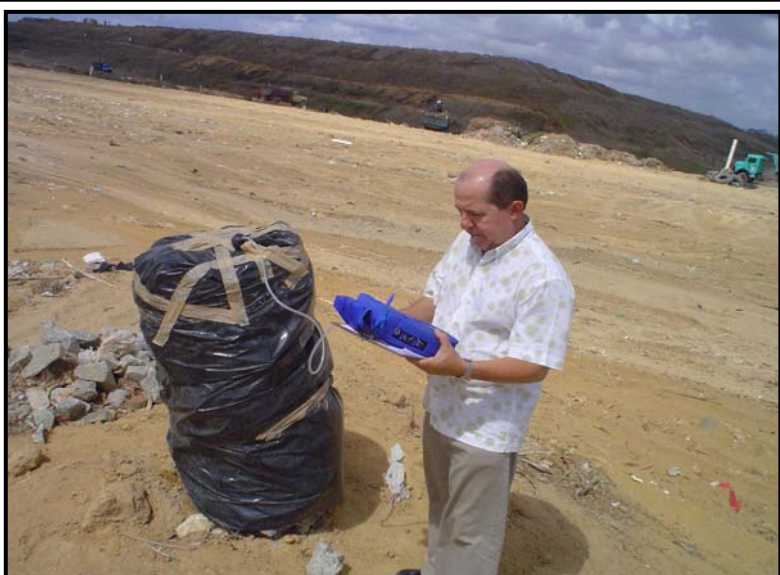
Medição de CH 4 , CO 2 e O 2 com célula selada por 48 horas e tempo de medição de 30 segundos
