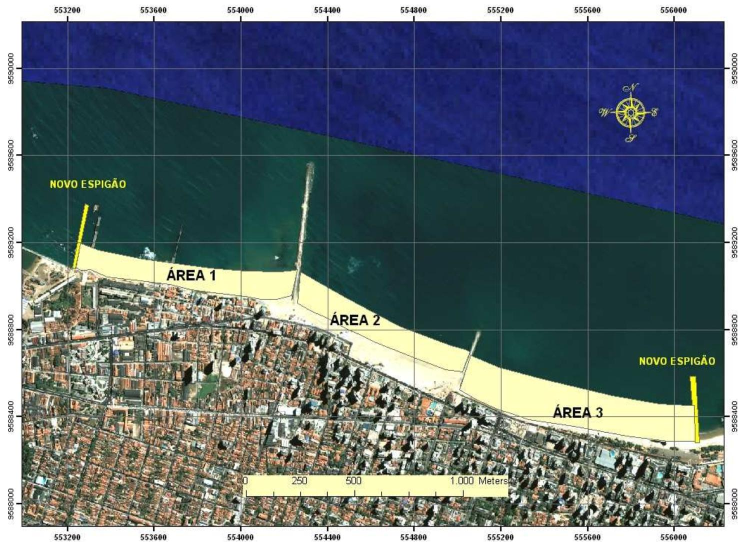
Figura 11: Layout da solução final para recuperação a praia de Iracema. Nesta solução existe a possibilidade de construção em duas etapas, com a construção de um espigão intermediário.
