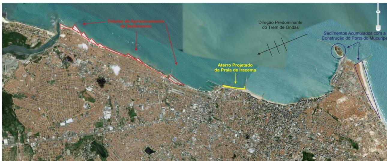
Figura 49: Deposição de sedimentos e direção média das ondas no litoral de Fortaleza. (Fonte: Google Earth 2008, adaptado pelos autores).
