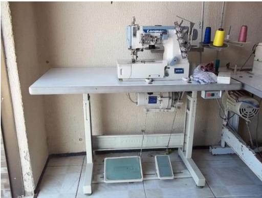
**Figura 10-Máquina Interloque.**
