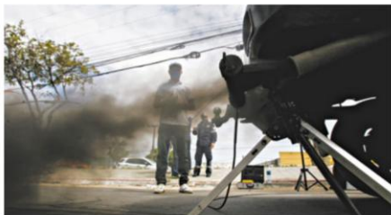
Técnicos analisavam a emissão de gases tóxicos dos veículos por meio do aparelho opacímetro, que mede a coloração da fumaça. Quando mais escura ela é, maior é a poluição gerada pelo motor. FOTO: NATINHO RODRIGUES
