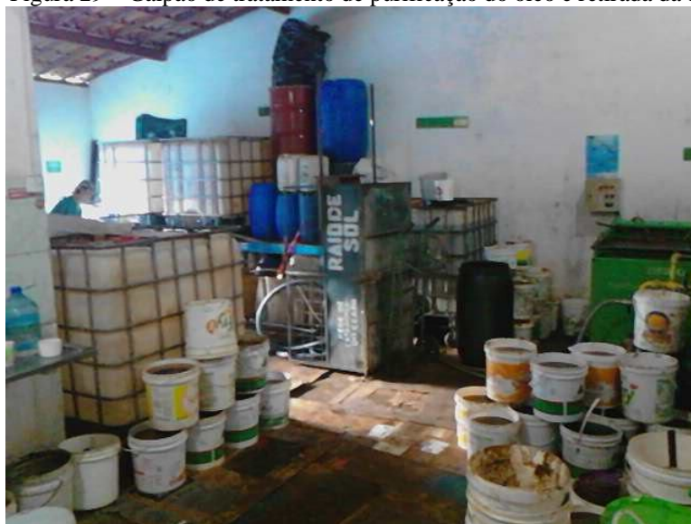
Figura 29 – Galpão de tratamento de purificação do óleo e retirada da borra
