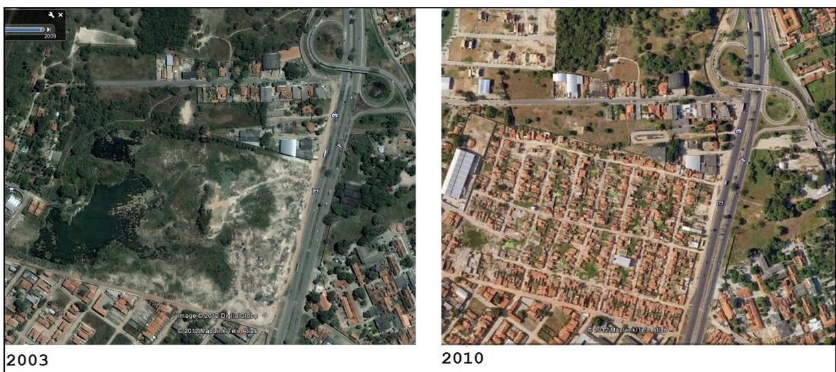
Figura 4.7 - Ocupação inadequada de lagoa ao longo da BR 116 próximo ao viaduto do Cambeba (coordenadas 9578413/555159 em abril de 2012)
