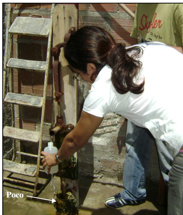
Figura 3.2.2 - Coleta de água no poço tubular com bomba manual (P134), localizado no Bairro São Gerardo, Fortaleza. Coord.: 9587690/549280 (Agosto/2010).
