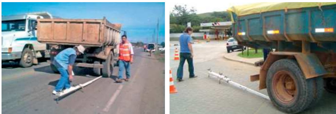
Figura 4.10 – Viga Benkelman. BERNUCCI et al. (2007).
