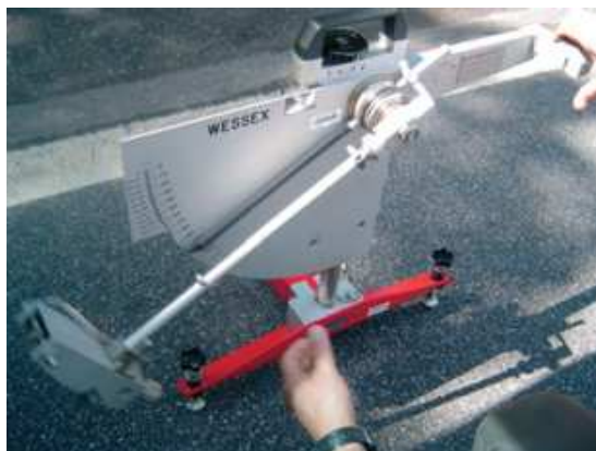
Figura 5.2 – Pêndulo Britânico. BERNUCCI et al. (2007).
