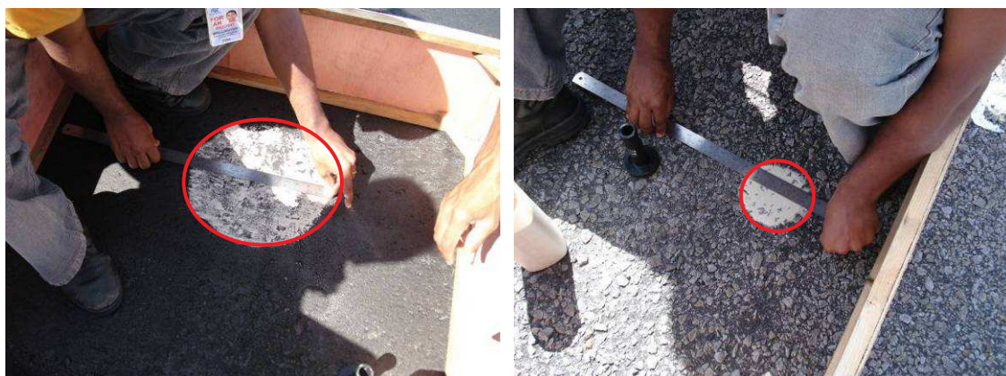
Figura 5.7 – Superfície com macrotextura fechada e aberta.
