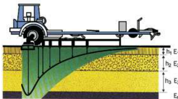
Figura 4.13 – Esquema de medida do FWD. BERNUCCI et al. (2007).
