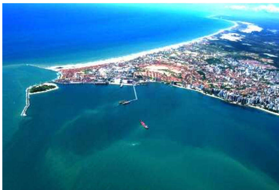
Foto 14: Acumulação de sedimentos dentro da área portuária, criando a denominada Praia Mansa.
