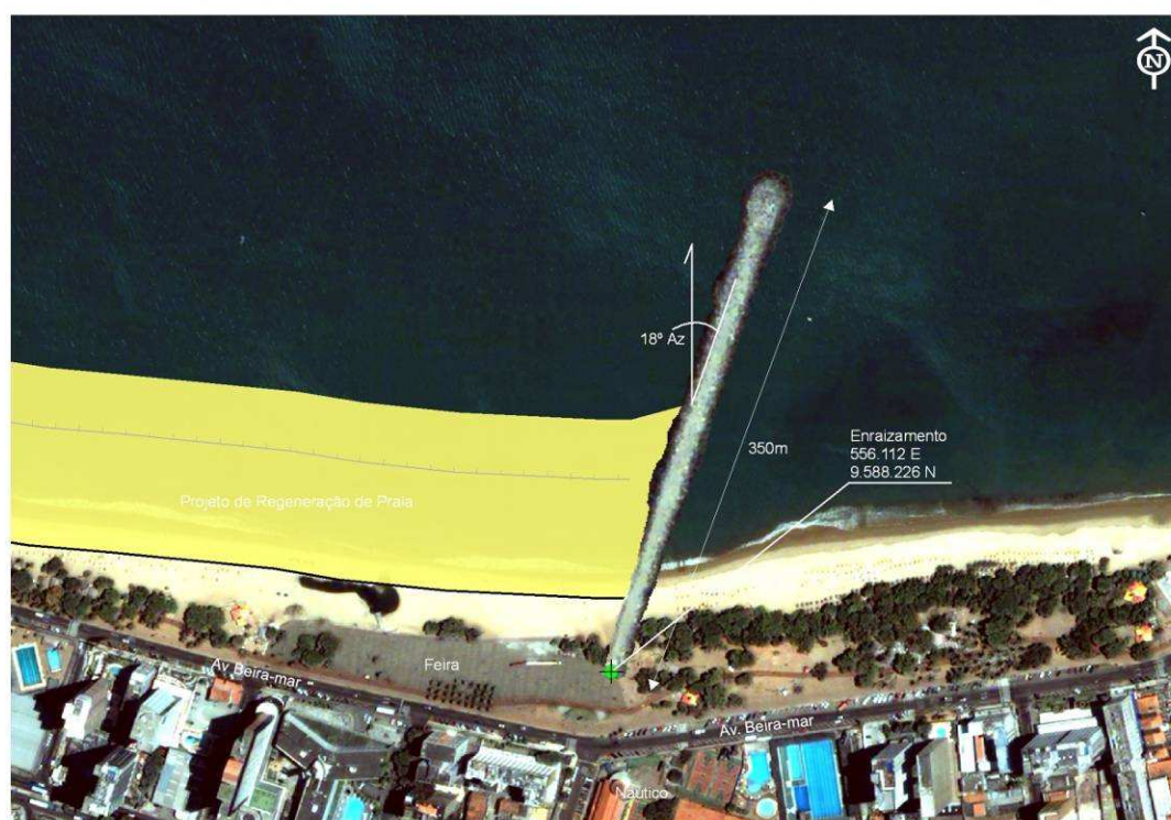
Figura 18: Disposição do Espigão de Contenção, Av. Desembargador Moreira.
