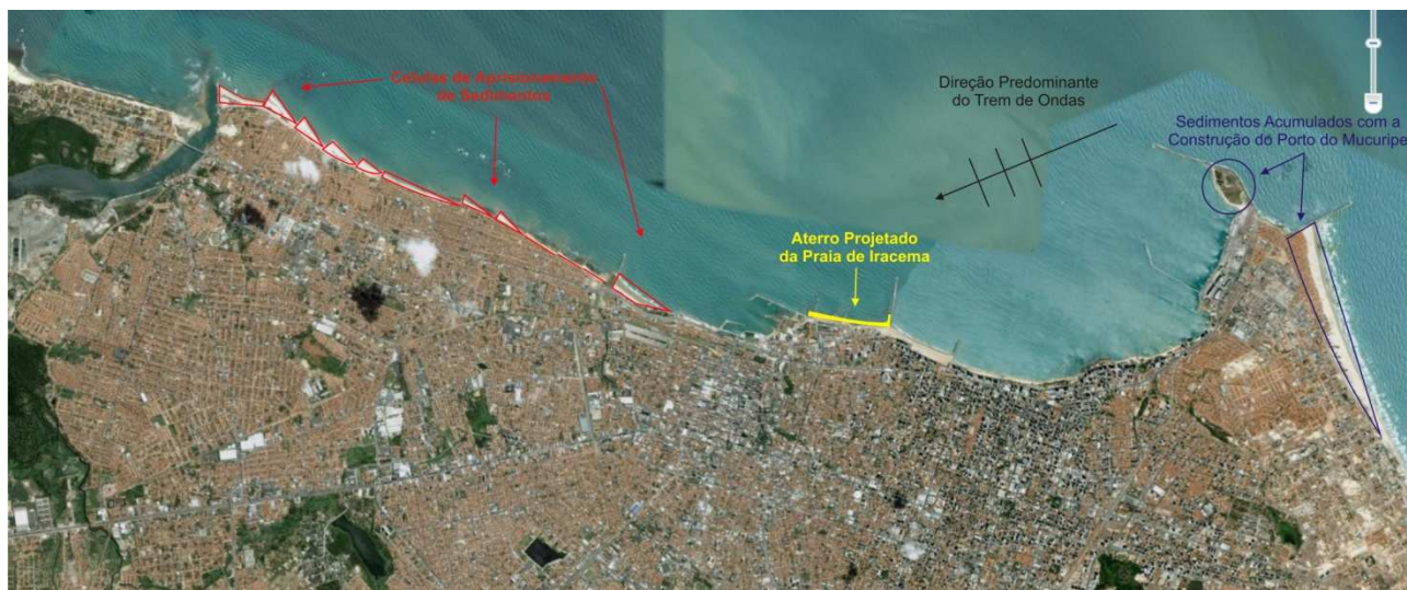
Figura 49: Deposição de sedimentos e direção média das ondas no litoral de Fortaleza. (Fonte: Google Earth 2008, adaptado pelos autores).
