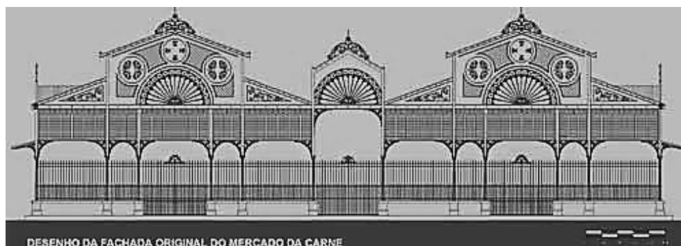
Figura 132 – Fachada pré-fabricada em ferro do Mercado da Carne
