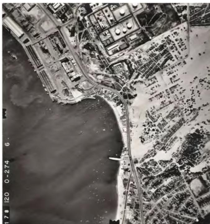
Foto 58 - Fotografia aérea de 1972, mostrando o sedimento eólico transportado das dunas do Mucuripe para o fundo da enseada, na altura do porto. Parte da areia foi retirada para construção do estacionamento do porto e acesso para a Praia do Futuro.
