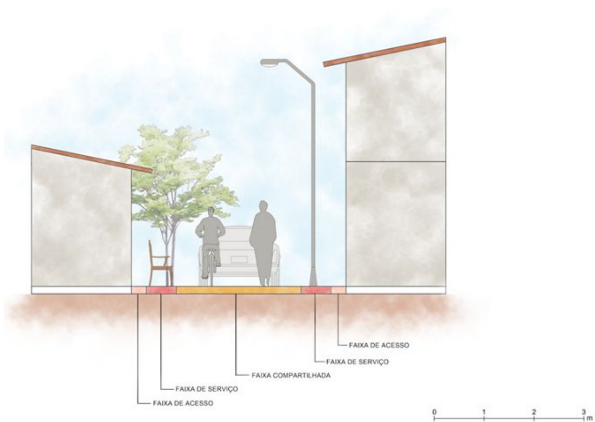
Figura 02: Corte esquemático da via compartilhada tipo B. Fonte: Equipe técnica UNIFOR, 2019. Elaboração: Equipe Técnica UNIFOR.
