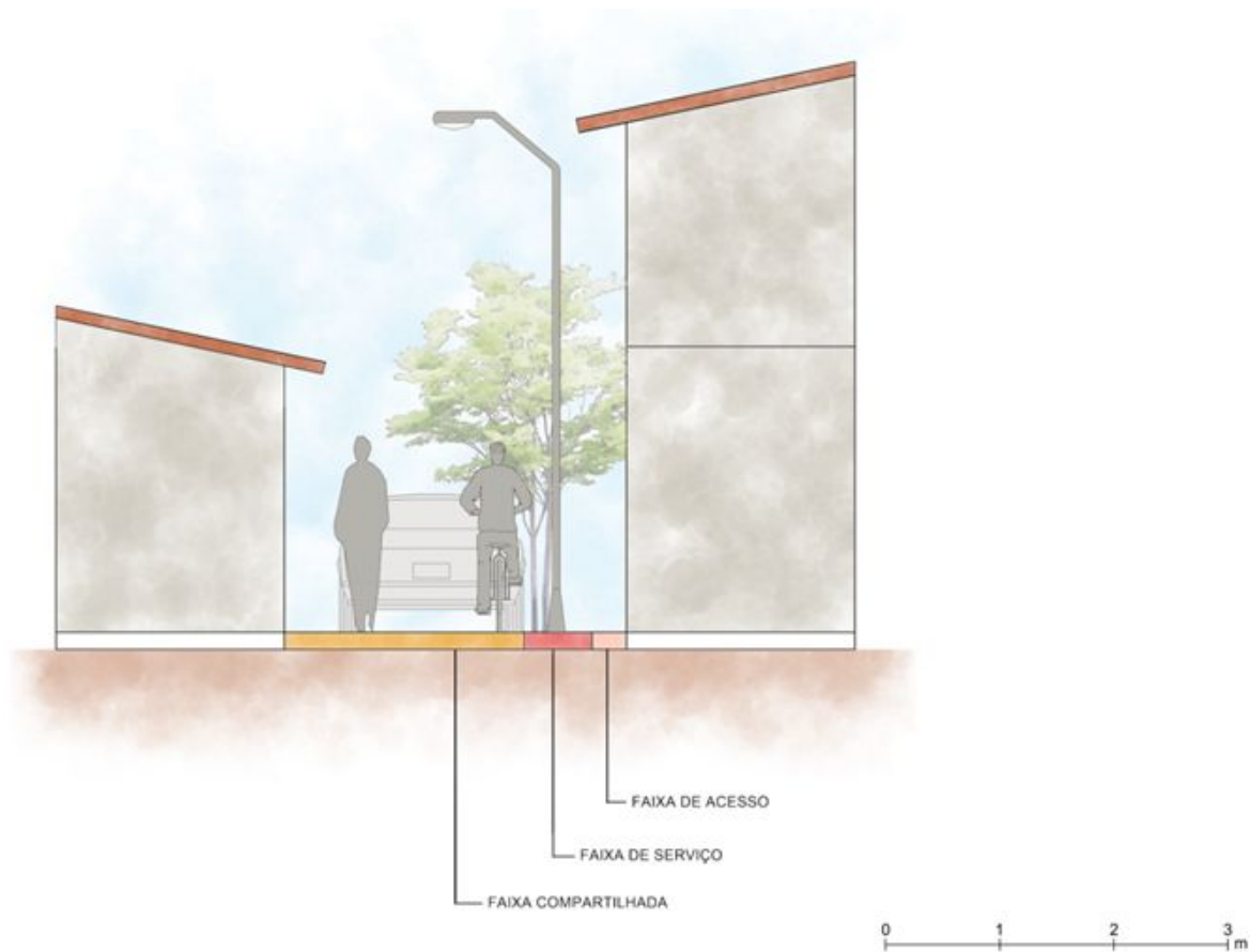
Figura 01: Corte esquemático da via compartilhada tipo A. Fonte: Equipe técnica UNIFOR, 2019. Elaboração: Equipe Técnica UNIFOR.
