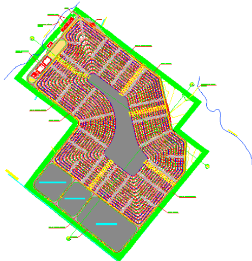
Figura 43. Layout da Última Etapa de operação do aterro de RSU de Caucaia-CE.
