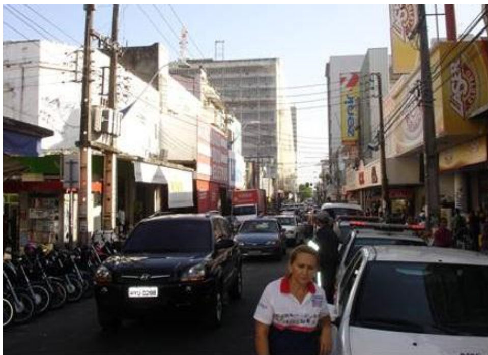
FIGURA Nº 23.34 – CAIXA DA VIA ESTREITA, COM ESTACIONAMENTO EM AMBOS OS LADOS, PERMITINDO A UTILIZAÇÃO DE APENAS UMA FAIXA DE TRÁFEGO – RUA BARÃO DO RIO BRANCO, BAIRRO CENTRO
