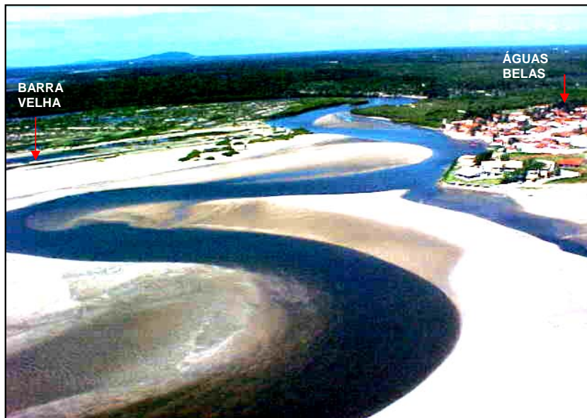
Figura 37. Disposição dos cordões arenosos que promoveram o avanço do canal estuarino e conseqüente erosão das estruturas urbanas em Águas Belas. Foto tirada em maio de 2002, na maré vazante de sizígia.
