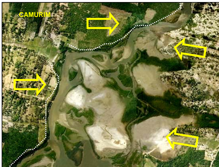
Figura 39. Áreas geradoras de sedimentos ( \Rightarrow ) incrementando o assoreamento do estuário. (Imagem na escala de 1:4.000 do ano de 1998 cedida pelo IPLANCE).
