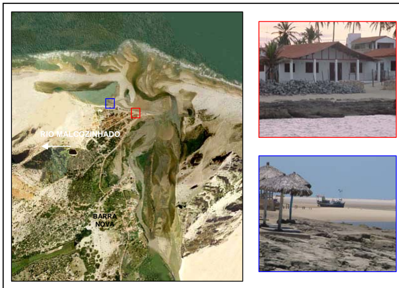
Figura 2. A ação conjunta da deriva litorânea e diminuição da vazão do rio promoveu a migração da foz do Rio Choro e a erosão da praia de Barra Nova, Cascavel-CE.
