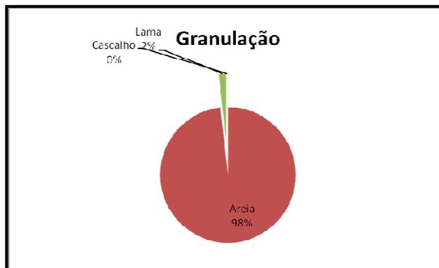
Figura 5.53 – Distribuição granulométrica para o ponto E16 do estirâncio.
