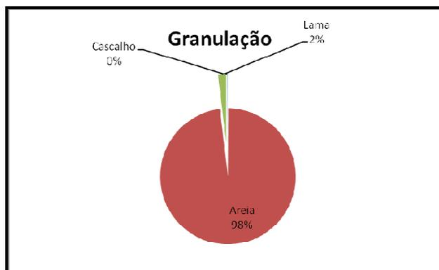
Figura 5.37 – Distribuição granulométrica para o ponto E5 do estirâncio.
