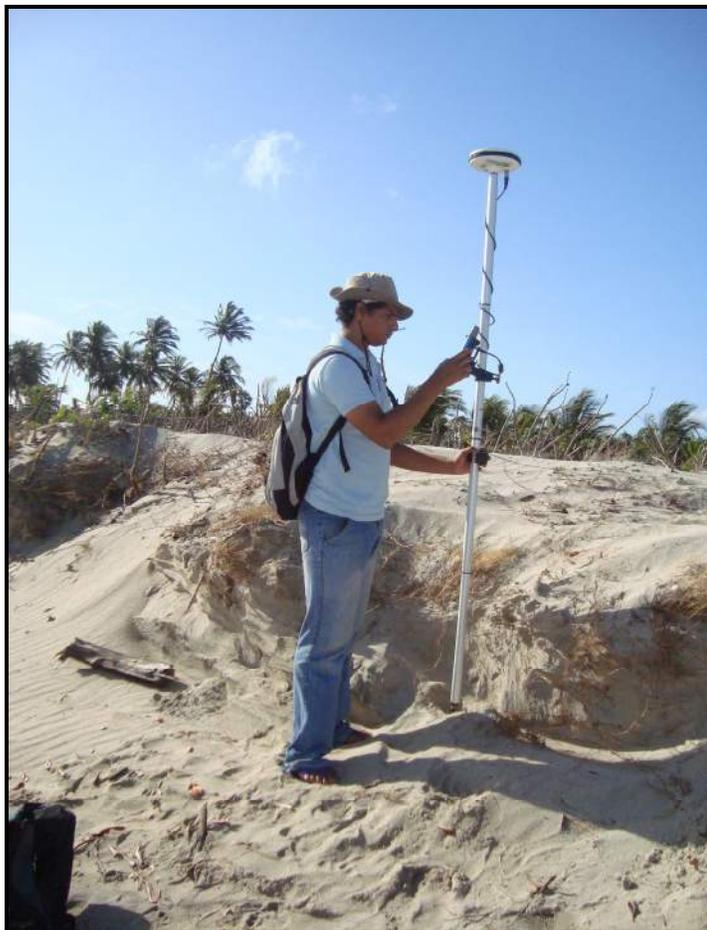
Figura 4.2 – Receptor DGPS para realização dos perfis topográficos.
