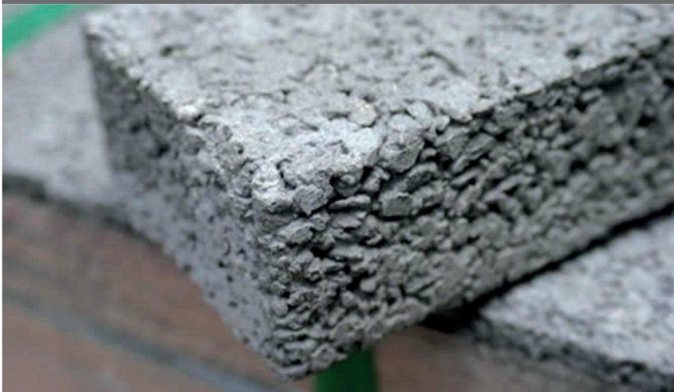
Figura 82 – Pavimento de concreto permeável
