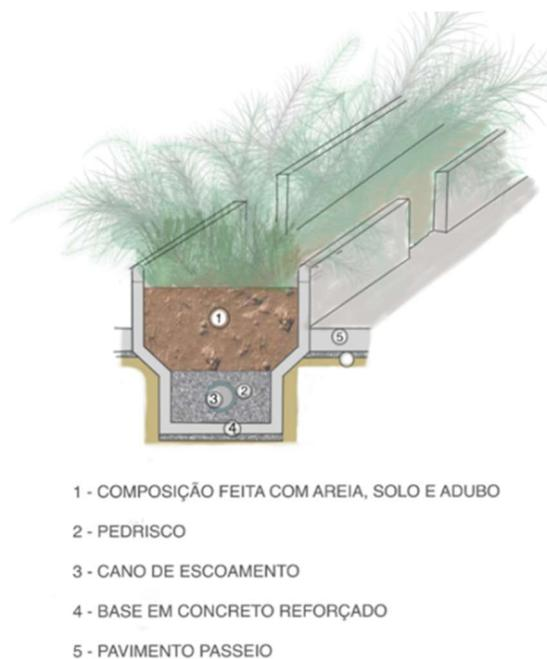
**Figura 5.6:** Exemplo de Biovaleta - corte esquemático
