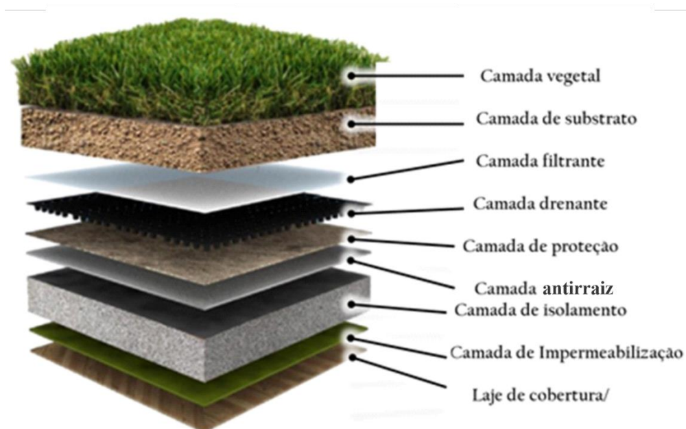
Figura 82 - Exemplo de Telhado Verde
