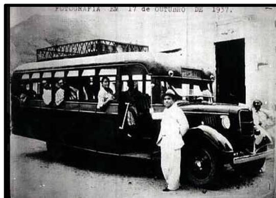
Veículos de transporte misto (pessoas e cargas) nas duas fotos superiores e caminhões adaptados para transporte de passageiros nas duas fotos inferiores. Na foto inferior à esquerda um observa-se um dos primeiros ônibus com carroceria de madeira feita no Ceará, provavelmente da década de 30 ou 40, e na foto inferior à direita, uma fotografia datada de 17/10/1957, observa-se um Ford V8, ano 1936, também com carroceria de madeira fabricada em Fortaleza.
