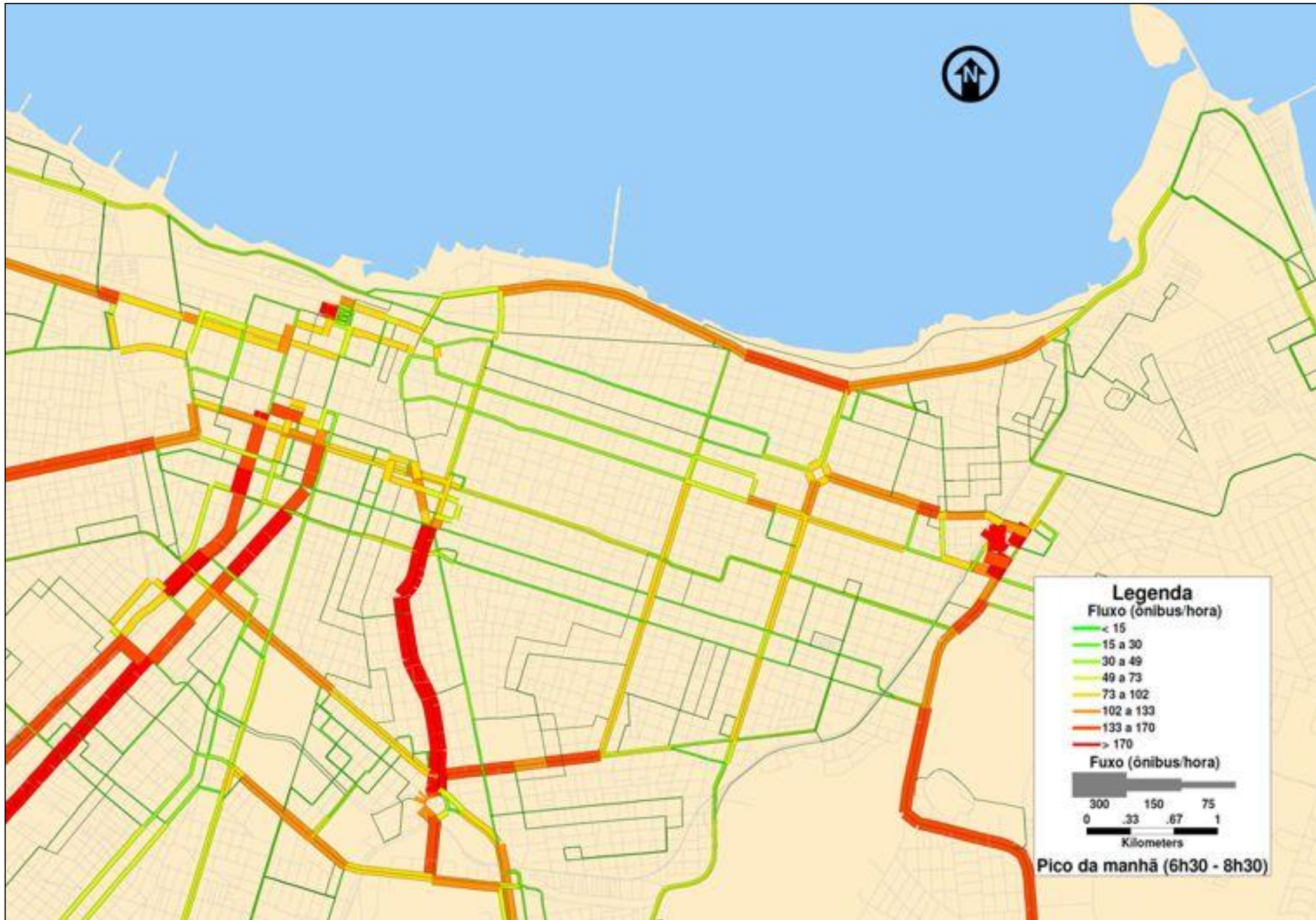
Figura 4.16: Fluxo horário de ônibus (oferta) no sistema viário durante o pico do tráfego da manhã - Sistema Urbano de Fortaleza - Detalhe
