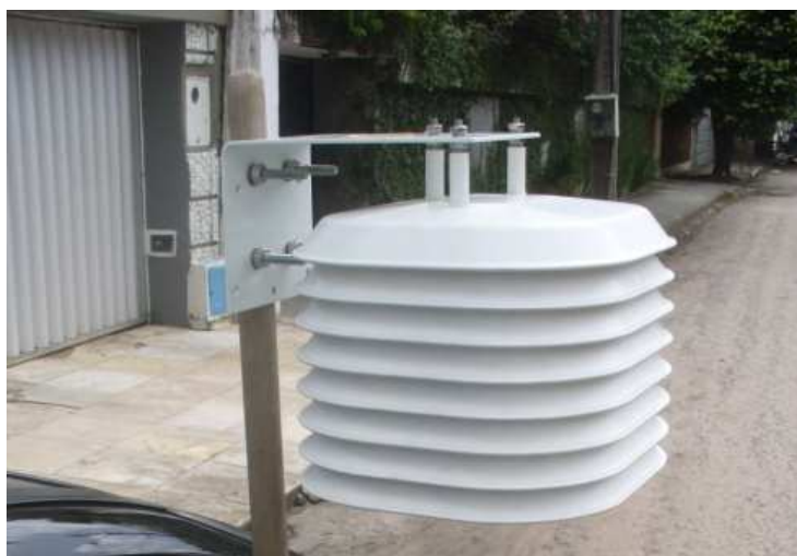
Figura 10: Adaptação do suporte para fixação do sensor em veículos.
