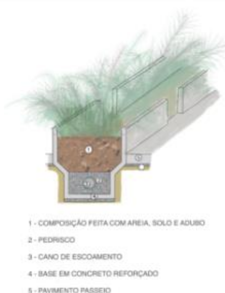
Figura 5.6.: Biovaleta - corte esquemático
