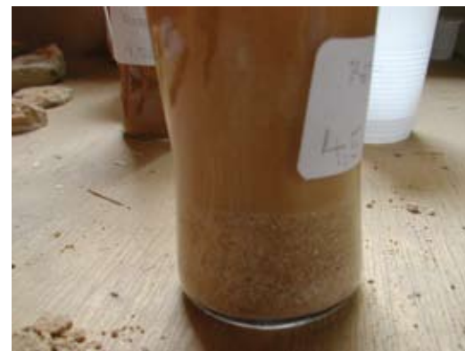
Fig.2.3 – Desagregar fragmentos de argamassas e avaliar empiricamente a granulometria, aglutinante e volume e granulometria do agregado por dissolução com ácido clorídrico ou muriático. lg. N.S. das Correntes, Penedo, AL.
