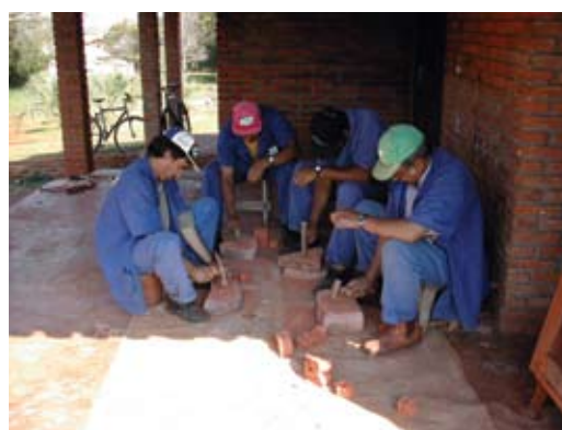
Fig. 3.6 – Moagem manual de pó de tijolo. Testes com argamassas. São Miguel das Missões,RS.
