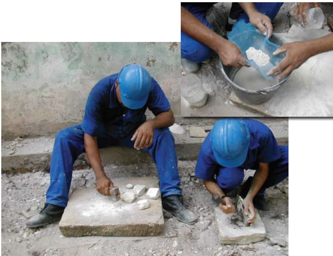
Fig. 3.5 – Moagem manual de calcário. Ig.N.S. Corrente. Penedo.
