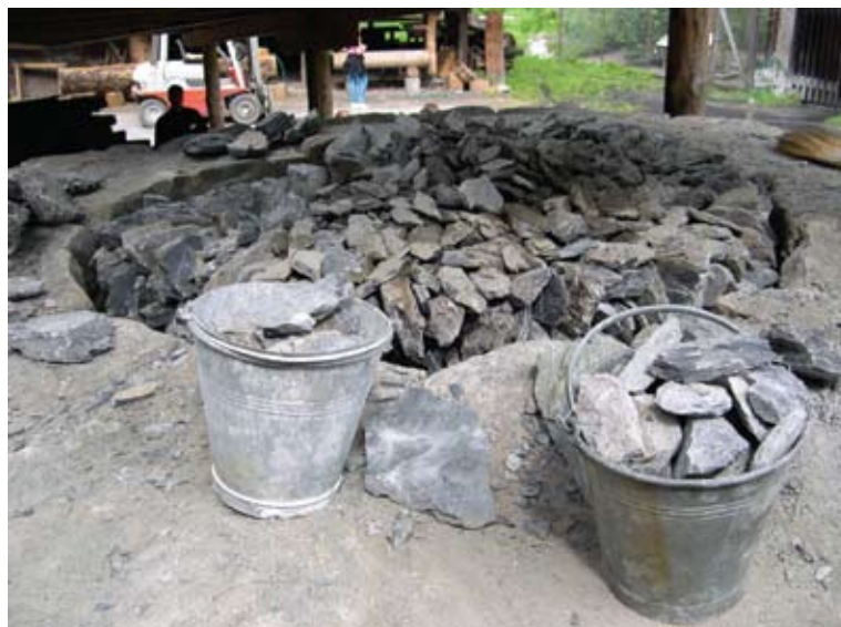
Fig.1.26 – Calcinação em forno tradicional. Pasta de cal hidratada por imersão em água, peneirada e maturada em tanque. Ballenberg, Suíça.
