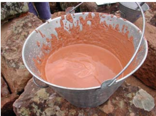
Fig. 3.16 – Teste de argamassa com pó de tijolo para reintegração de núcleos. São Miguel das Missões, RS.
