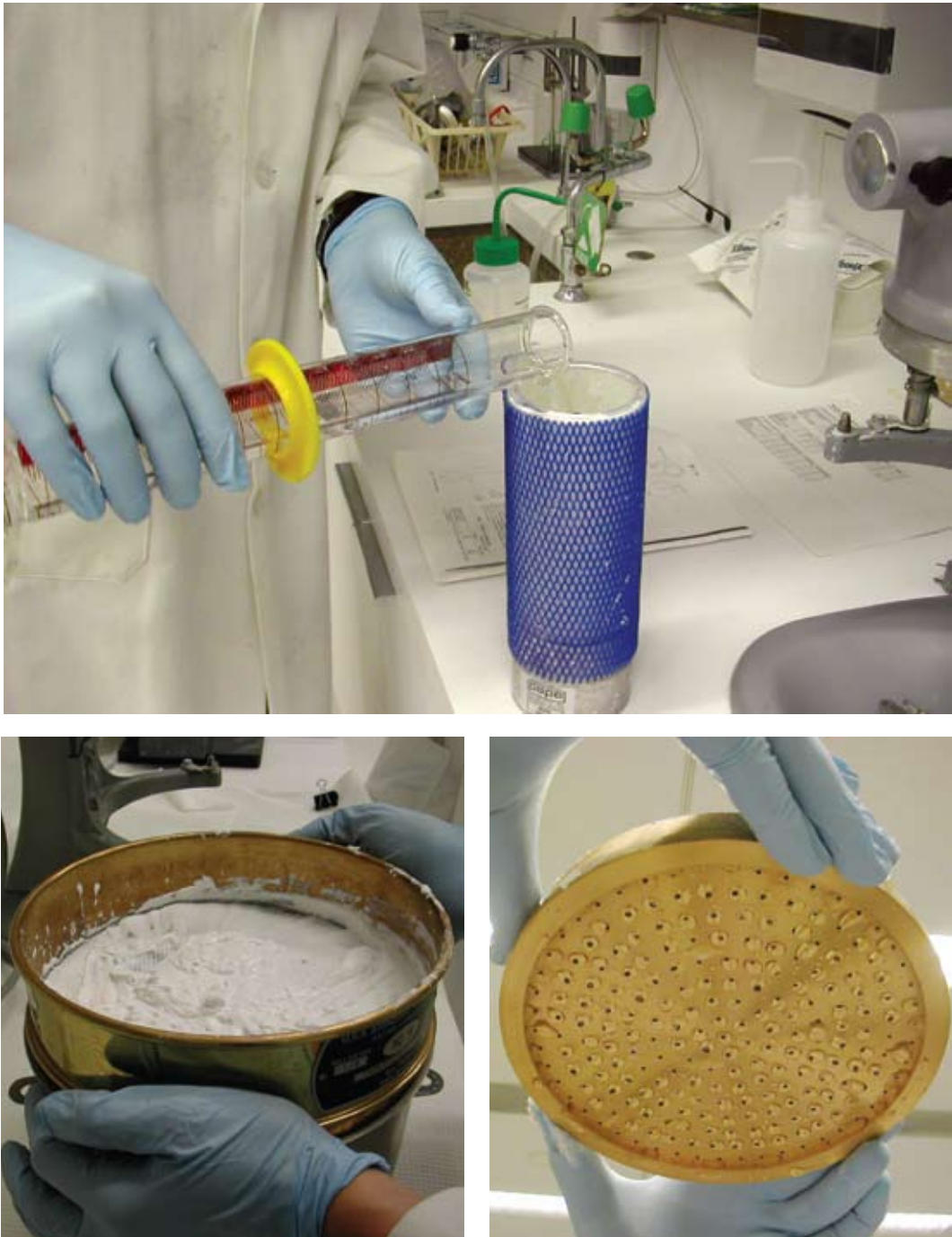
Fig. 2.12 – Caracterização da cal em laboratório: reatividade, retenção de água, consistência e plasticidade da pasta. Instituto de Conservação Getty.
