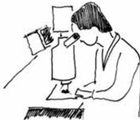
Fig. 2.2 – Passos iniciais para analisar argamassas antigas: observar in loco , observar com lupas, documentar, observar absorção de água; se possível, usar microscópio.
