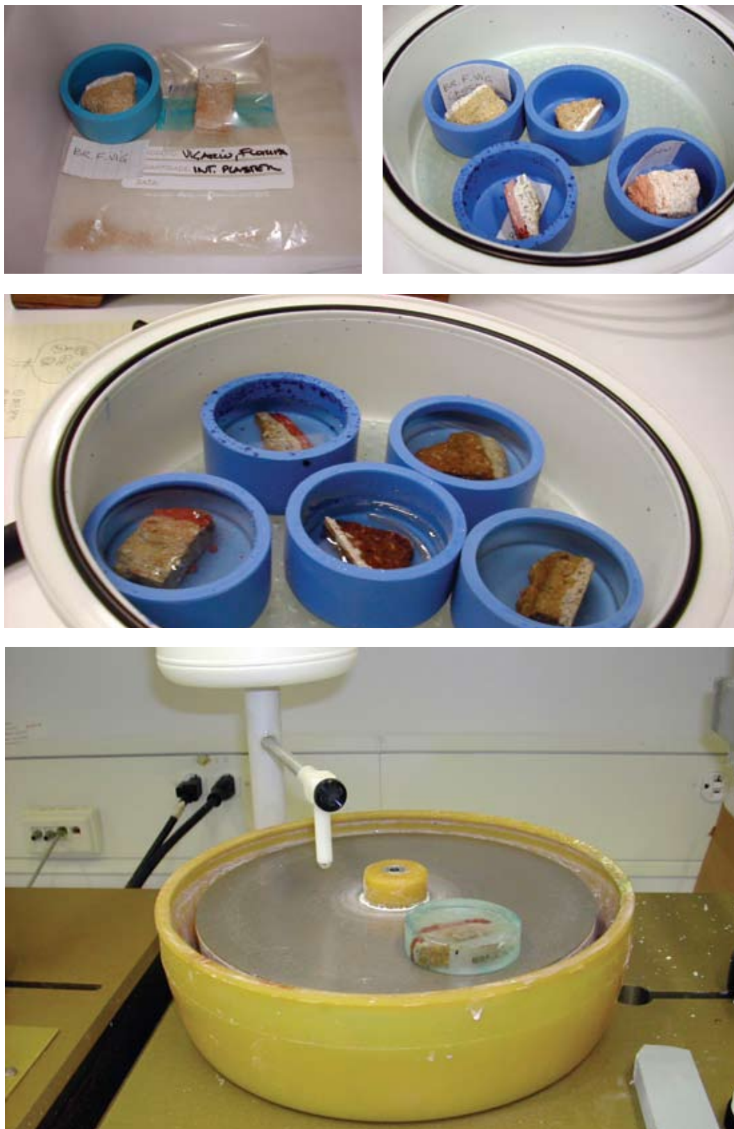
Fig. 2.6 – Preparação de cortes estratigráficos com resina e posterior polimento. Instituto de Conservação Getty.
