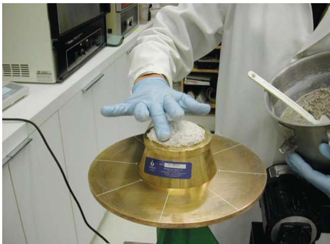
Fig. 2.13 – Caracterização da consistência da argamassa e posterior moldagem de corpos de prova: 5X5X5 e 4X4X16 em moldes de borracha e metal. Instituto de Conservação Getty.
