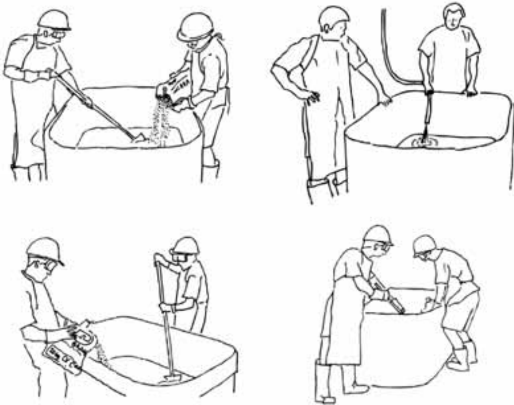
Fig. 3.3 – Passos para hidratar a cal no canteiro da obra.
