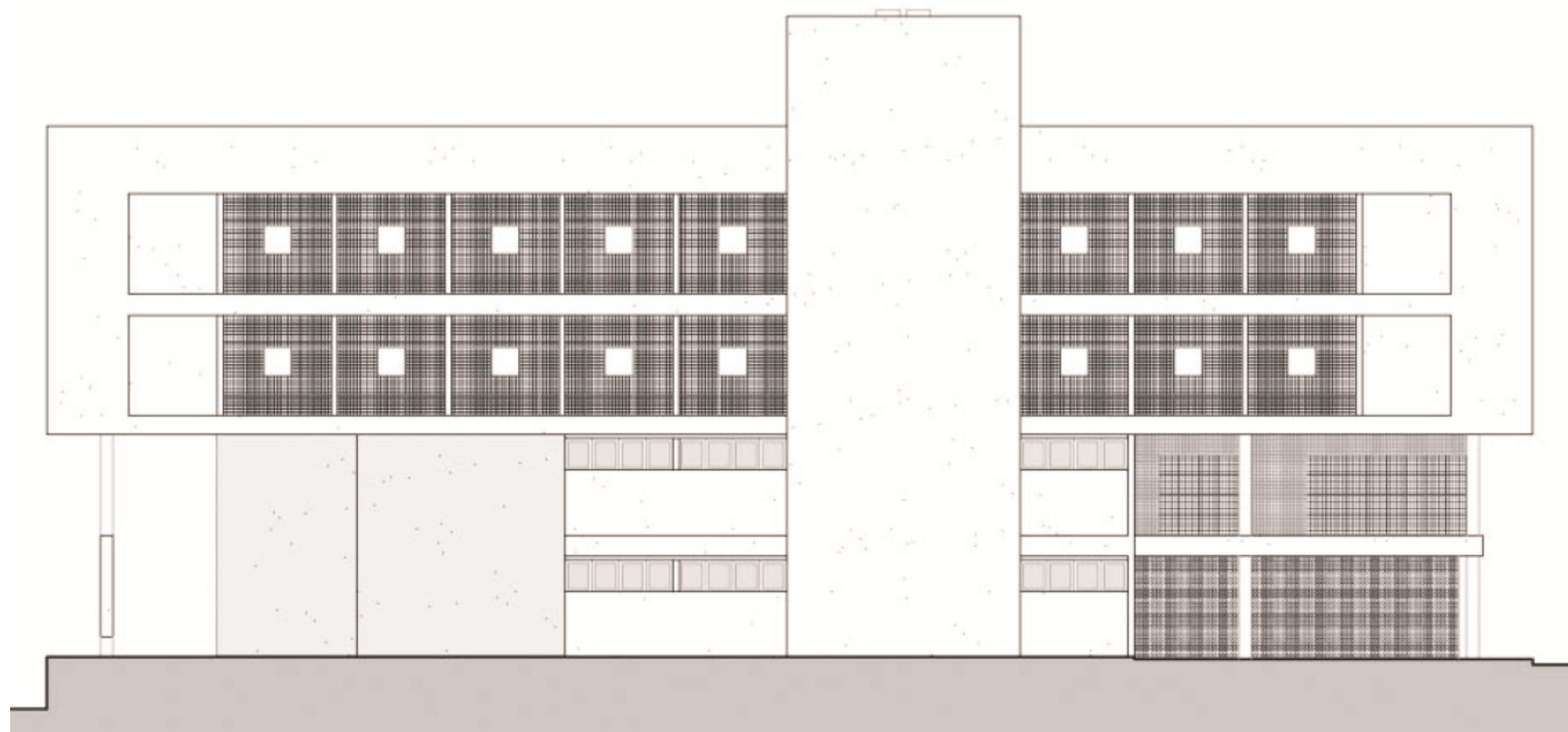
Fig. 39 – Vista posterior com as vedações das circulações dos apartamentos e os cobogós no pilotis
