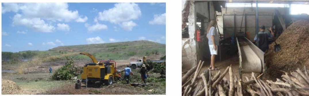
Figura 41. Fotos da trituração de resíduos de podaço e fabricação de briquetes
