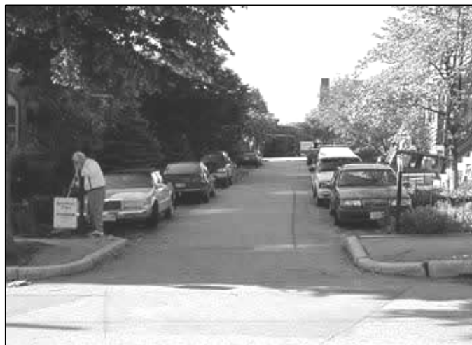
Figura 5.14: Prolongamento da calçada em área de travessia de uma via com estacionamento de veículos paralelo ao meio-fio (Fonte: PBIC, 2005).
