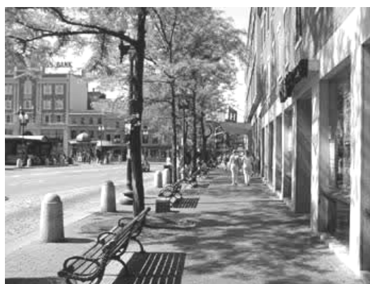
Figura 5.15: Disposição adequada do mobiliário urbano ao longo da faixa de serviço da calçada (Fonte: PBIC, 2005).
