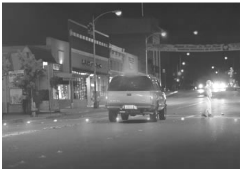
Figura 5.17: Área de travessia intensamente iluminada com faixa de pedestres ressaltada através de lâmpadas (Fonte: PBIC, 2005).
