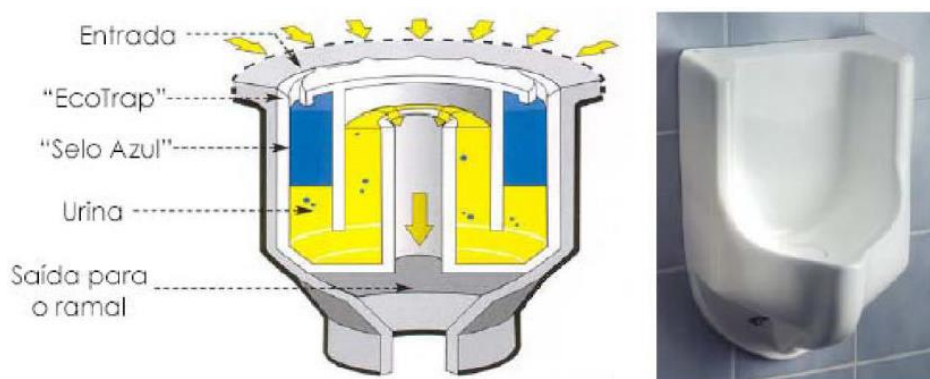
Figura 18. Esquema de um mictório sem uso de água e vista do aparelho. Fonte: SCHERER, 2003.
